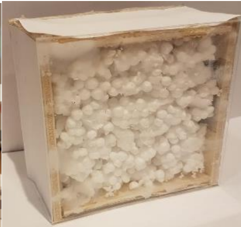
Dit is tussen de muren in bij spouwmuurisolatie, waarbij je kunt zien dat er bij deze muur geïsoleerd is.
