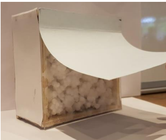
Dit is tussen de muren in bij spouwmuurisolatie, waarbij je kunt zien dat er bij deze muur geïsoleerd is.
